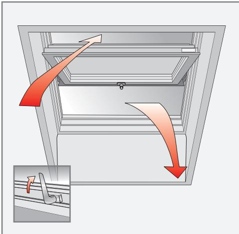
**D Normal- und Lüftungsöffnung.**
